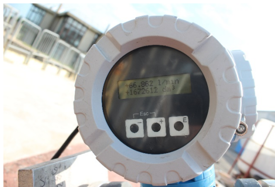
Figure 6 - Débit d'alimentation en eau lors de l'essai
