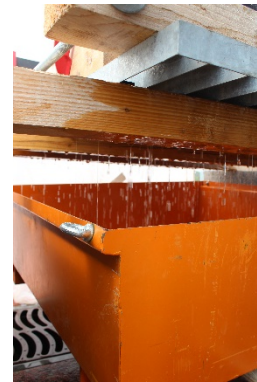
Figure 5 - Infiltration à travers le revêtement
