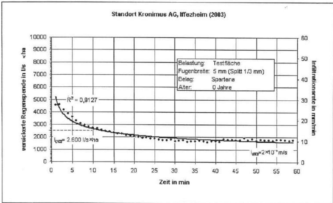
Darstellung 1: Infiltrationsgang auf der Untersuchungsfläche.
