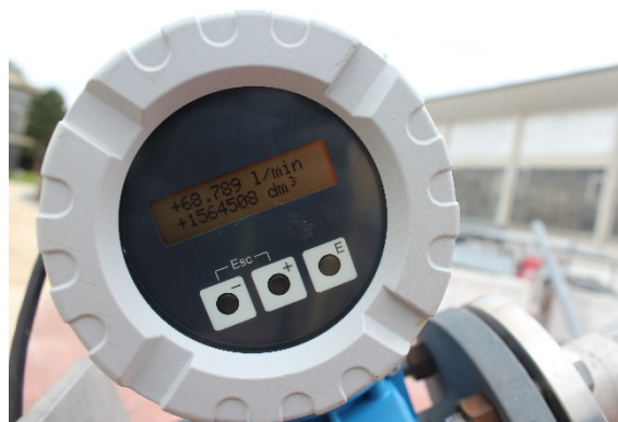
Figure 6 - Débit d'alimentation en eau lors de l'essai
