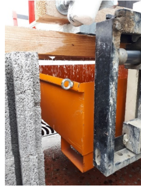
Figure 5 - Infiltration à travers le revêtement
