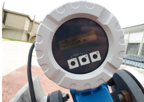
Figure 6 - Débit d'alimentation en eau lors de l'essai
