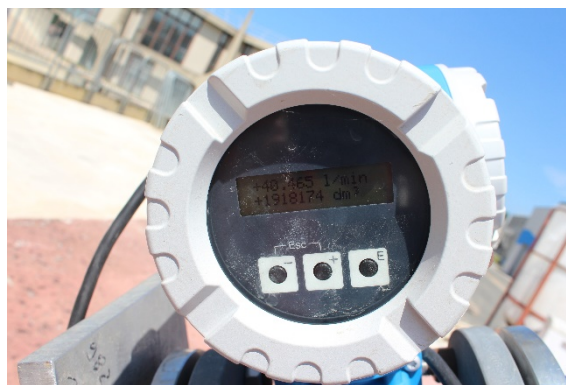
Figure 6 - Débit d'alimentation en eau lors de l'essai
