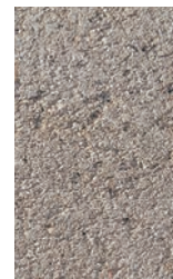
La société Kronimus garantit une perte de masse moyenne presque 14 fois inférieure - soit une perte maximale de \leq 0,075 \text{ kg/m}^2 .
